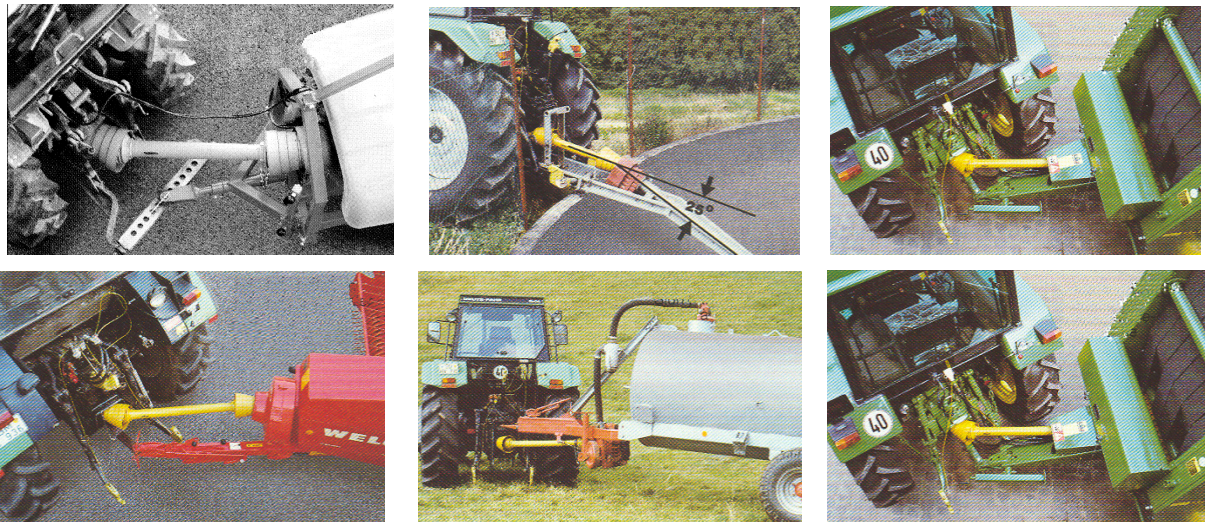
Сл. 12.10: Примена кардановог вратила за погон радних органа прикључних машина
