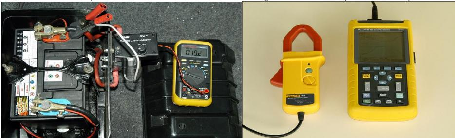
Sl. 7.35. Oprema za merenje jačine struje elektropokretača
