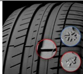
*Sl. 0.7. Indikator istrošenosti pneumatika*
