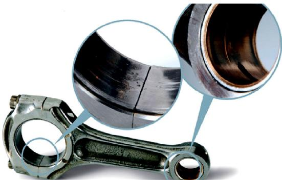
*Sl. 2.3. Habanje kliznih ležajeva velike i male pesnice klipnjače nastalo kao posledica dugotrajnog rada motora
