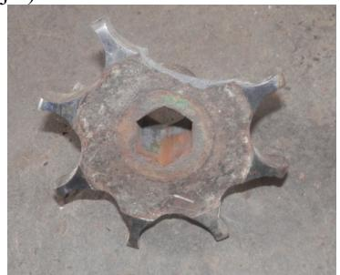
*Sl. 2.10. Neispravnost pogonskog sistema prese za seno nastalo kao posledica tehničkog kvara lančanika. Pogonski lančanik pretrpeo je veliko oštećenje. Oštećenje lančanika (pučanje zuba) nastalo je kao posledica zamora materijala, usled dugotrajnog korišćenja.*
