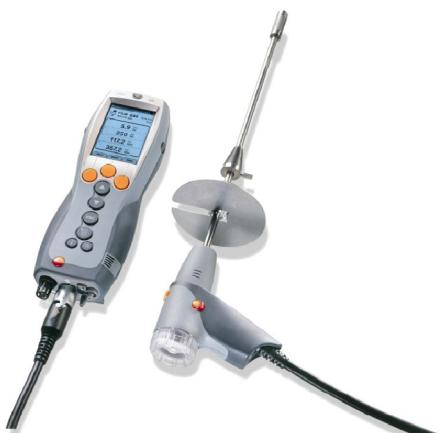
Sl. 7.38. Analizator izduvnih gasova Testo 335 namenjen direktnom očitavanju sastava izduvnih gasova
