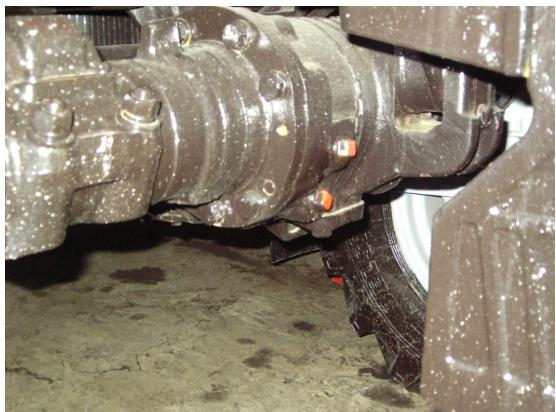
Sl. 6.17. Čepovi za ispuštanje i dolivanje ulja u kućištu diferencijala prednjeg pogonskog mosta traktora MTZ 820
