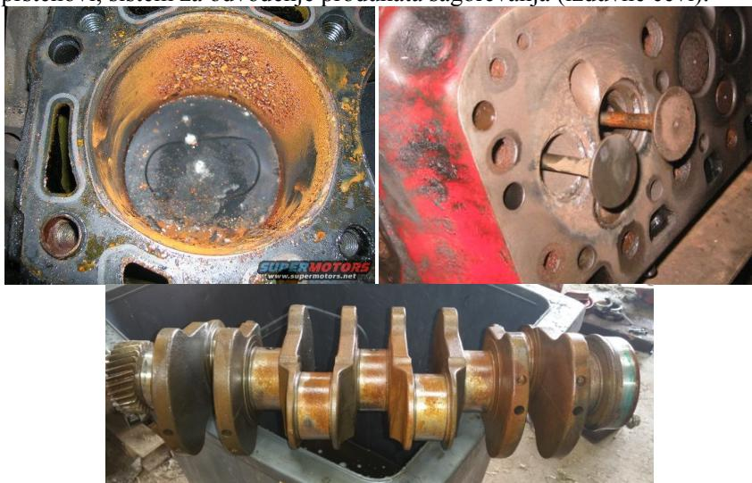
Sl. 9.1. Korozija cilindra, ventila i kolenastog vratila motora nastala kao posledica dugotrajnog garažiranja
