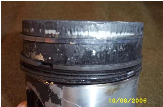
Sl. 8.25. Koksovanje klipnih prstenova nastalo kao posledica primene lošeg motornog ulja
