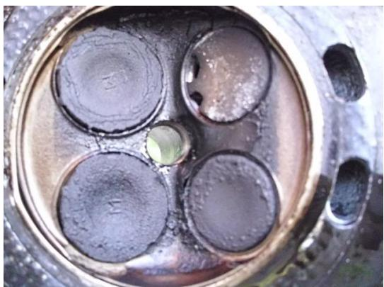
Sl. 3.3. Pregoreli ventil (mogući uzroci: premali zazor ventila drži ventil otvoren, čestice čadi sprečile zatvaranje ventila, zaglavljen ventil u vođici, deformisana opruga ventila, što uzrokuje nedovoljno hlađenje)
