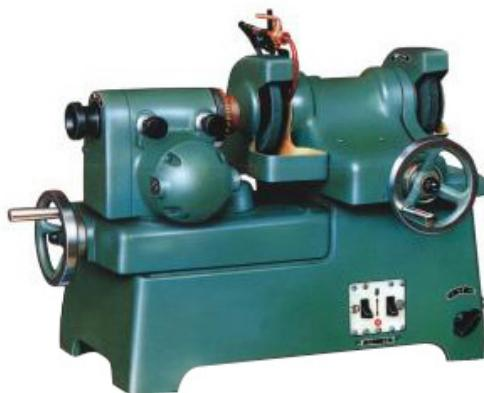
*Sl. 5.85. Mašina za obradu sedišta ventila (maksimalan prečnik  $\Phi 90$  mm, opseg prečnika ventila  $\Phi 25\text{-}\Phi 90$  mm, prečnik stabla ventila  $\Phi 6\text{-}\Phi 16$  mm, ugao brušenja  $30^\circ\text{-}60^\circ$ , broj obrtaja ventila  $180\text{-}300$  o/min, broj obrtaja tocila  $4500$  o/min, maksimalna dubina brušenja  $0.025$  mm, dimenzije maštine ( $L \times W \times H$ )  $630\text{x}410\text{x}500$  mm)*
