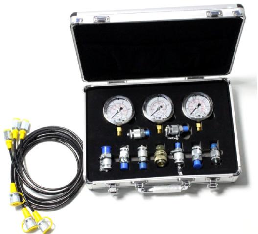
Sl. 7.14. Garnitura manometara i pripadajućeg pribora (fleksibilna creva i odgovarajući priključci-adAPTERI) namenjena dijagnostici stanja hidrauličnog sistema
