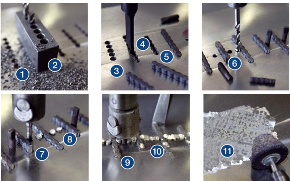
Sl. 5.115. „Metalock“ postupak reparacije pukotine (izvor: Metalock Engineering DE-Metalock repairs)
