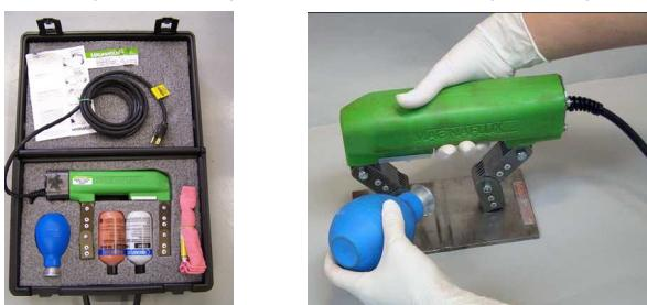
Sl. 5.21. Oprema za Magnaflux metod ispitivanja postojanja puktina
