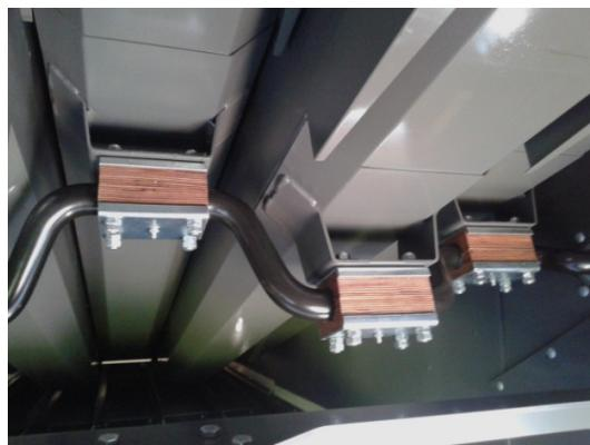
*Sl. 9.7. Drveni klizni ležajevi na slamotresu kombajna FENDT*
