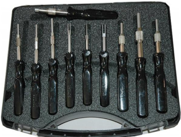
Sl. 7.113. Namenski alat za zamenu kontaktnih površina žica konektora
