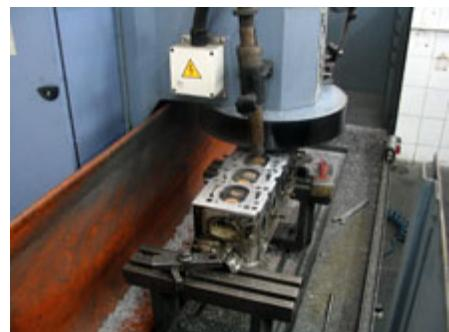
Sl. 5.71. Ravnjanje cilindarske glave primenom brusilice sa segmentnim radnim kolum
