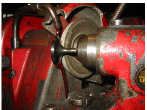
Sl. 5.84. Obrada nalegajuće površine ventila brušenjem
