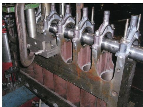
*Sl. 5.41. Obrada ležišta kolenastog vratila motora*
