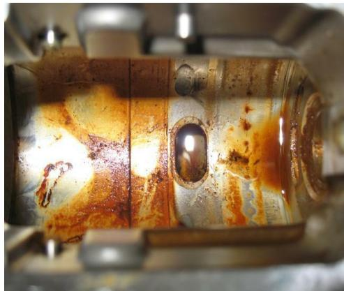
Sl. 9.3. Korozija elemenata sistema za napajanje motora gorivom
