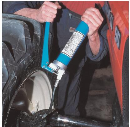
Sl. 6.10. Podmazivanje primenom „dekalamit“ mazalice
