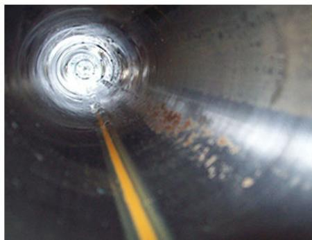
*Sl. 9.5. Korozija unutrašnje površine hidrauličnog cilindra (posebno je izražena kod jednosmerne hidraulike)*
